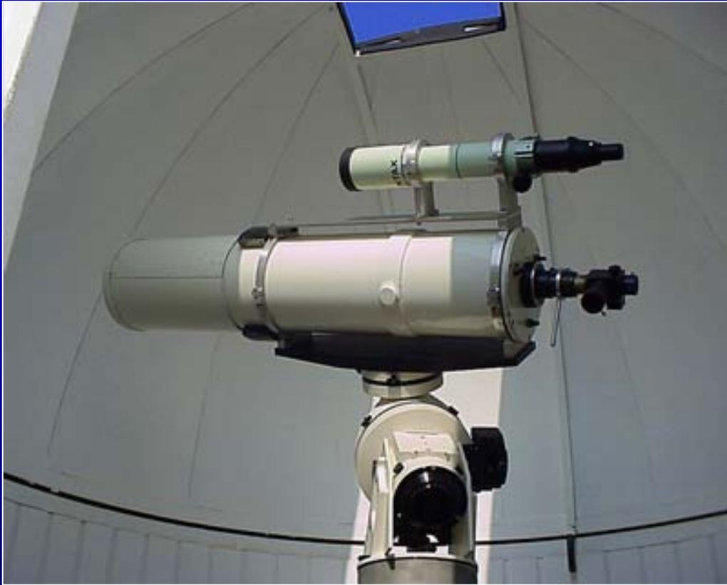
Il telescopio principale è un Newton-Cassegrain Marcon di 200mm f/5-15, attualmente in configurazione Cassegrain. In parallelo è installato un rifrattore apocromatico Pentax SDHF da 75 mm. La montatura è una AstroPhysics 1200GTO.
