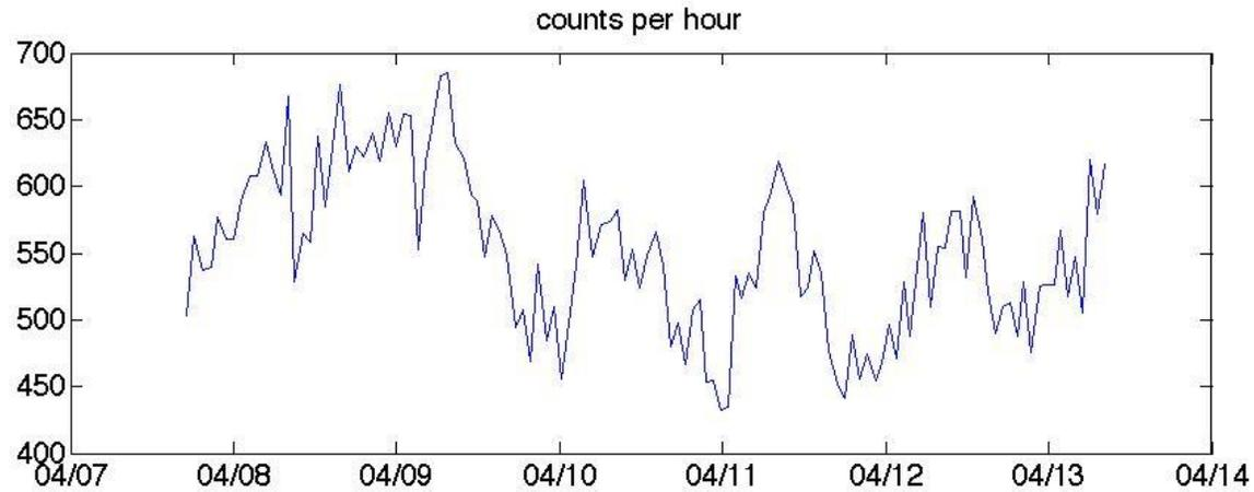
La tonalite emana quasi 2 ordini di grandezza meno radon rispetto al tufo ma riusciamo a misurarla lo stesso in real time (misure significative sampling time ~5 min)
