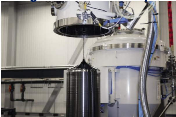
Lingot Cz en sortie de puller
